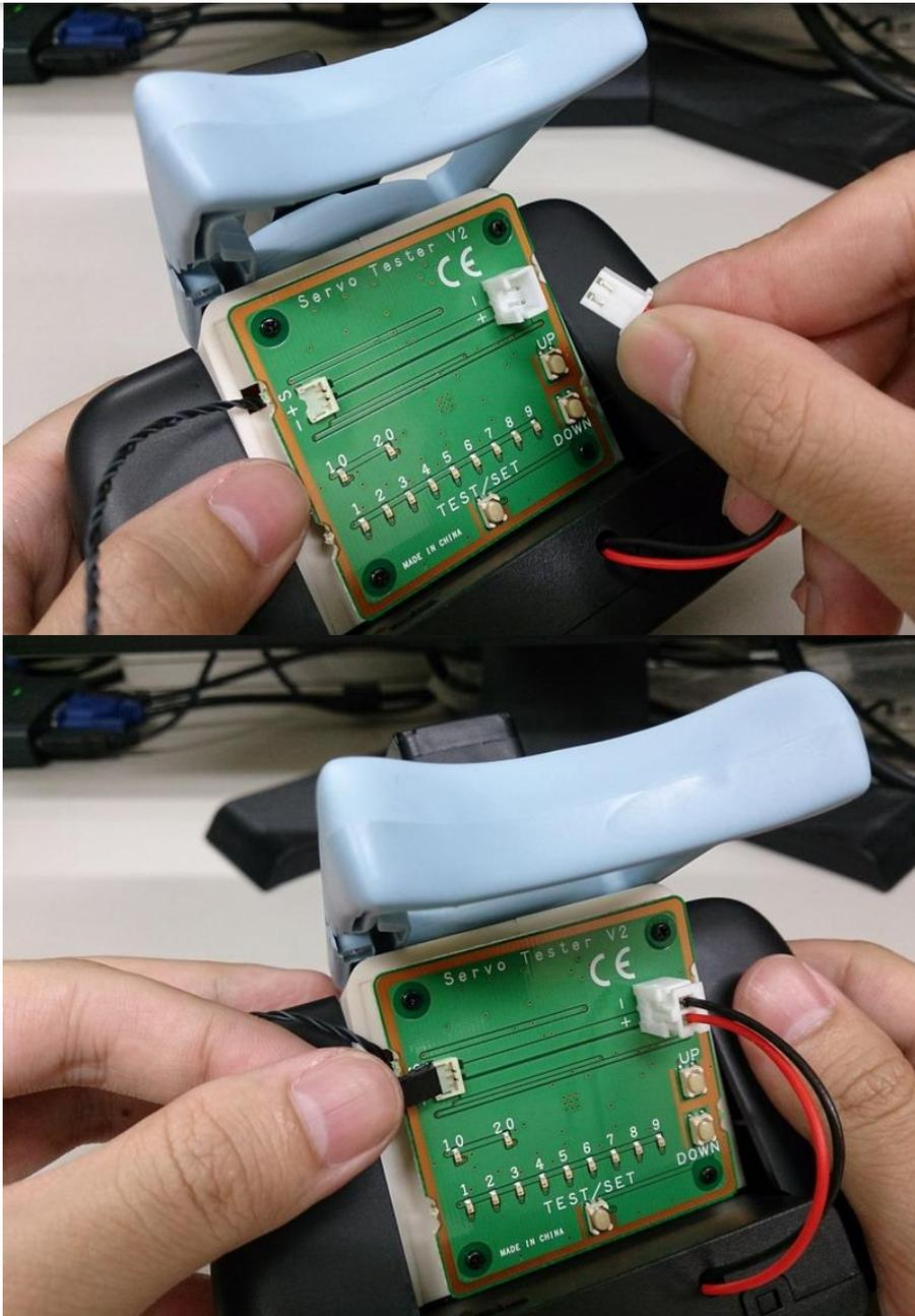
最後把馬達電線·電池盒電線都接上測試板~
